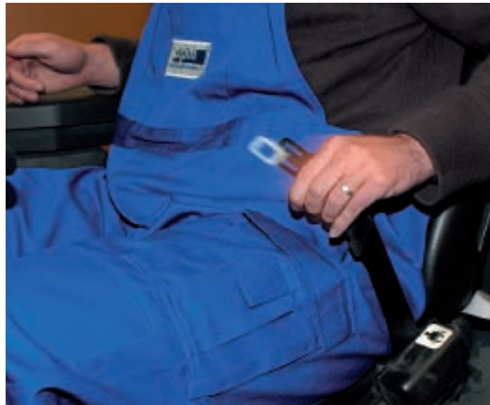
Sichere Fahrt im Stapler: Nur mit Gurt oder einem anderen Fahrerrückhaltesystem.
